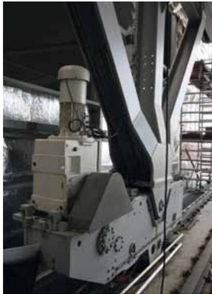
Lorsque la toiture se ferme 'en coulissant' sur les roues, la construction s'abaisse de 50 cm au milieu !
